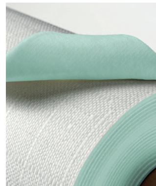
La gama de revestimientos SYSTEXX AcousTherm está tejida con fibras de vidrio y su parte posterior está recubierta con una capa especial de fieltro acústico que absorbe el sonido (nivel de absorción acústica  $\alpha_w$  de 0,25 (H), DIN EN ISO 354). Combina las sobresalientes propiedades técnicas que comparten todos los productos SYSTEXX y una característica adicional como es la de la absorción acústica, por lo que limita el volumen del ruido generado y su alcance.
