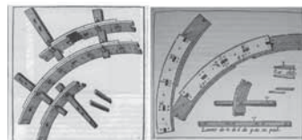
Fig.4: Características constructivas de las cerchas en camonadas de De L'Orne, formadas por camones y contracamones atravesados por espigas pasantes que hacen la función de rios-tras. Características y dimensiones de los camones, contracamones, espigas y clavijas de madera. (DE L'ORNE, 1561, f.9-10v)
