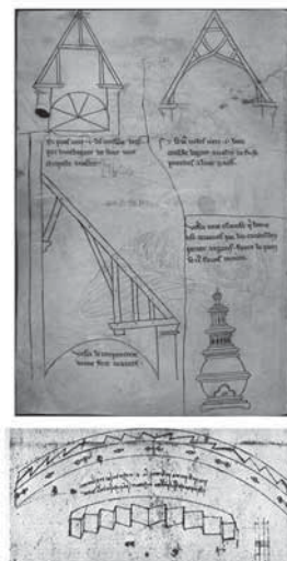
Fig.2. Armaduras de cubiertas en el cuaderno de Villard de Honnecourt. La figura superior derecha muestra rios-tras curvadas para formar la armadura. (DE HONNECOURT, 1235, f.34). Cercha de Leonardo, cuyas piezas presentan uniones en diente de sierra y clavijas metálicas. (HAHMANN, 2006, p.1503).
