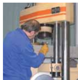
Colocación de la viga centrada en la máquina de ensayo.
