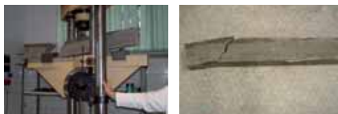
Rotura en momento mínimo de la viga.
