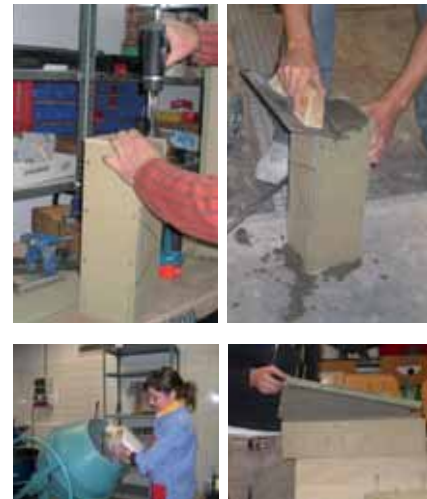
Fig.2-5.- Elaboración de probetas. (Fabricación de moldes; Fabricación del hormigón; Relleno de las probetas; Desmoldado).
