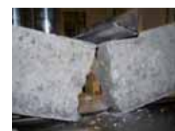
Rotura en momento máximo de la viga.
