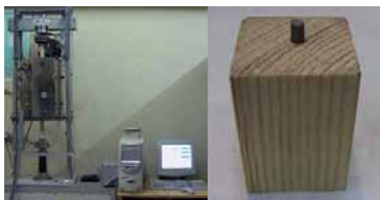
Figura 4. a) Máquina para los ensayos de adherencia entre el bioSiC y la madera de abeto, b) probeta.
