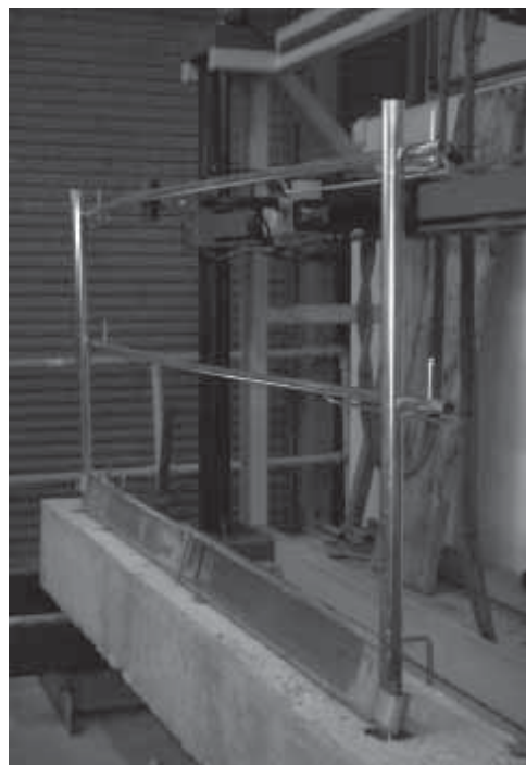
Figura 10: Ensayo de resistencia última sobre el centro de la barandilla principal.
