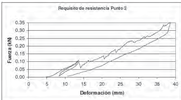
Figura 8: Gráfica Desplazamiento/Tiempo correspondiente a la evaluación del requisito de desplazamiento aplicando la carga en el Punto 3 (punto central del rodapié). Fuente: AIDICO.
