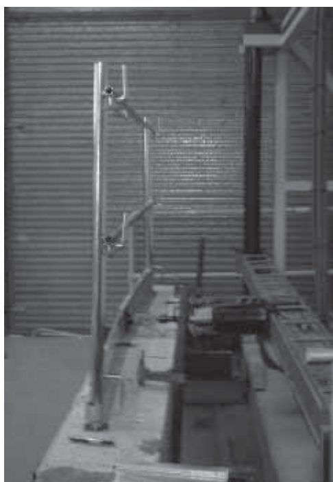
Figura 9: Ensayo de resistencia aplicando la carga sobre el centro del rodapié.
