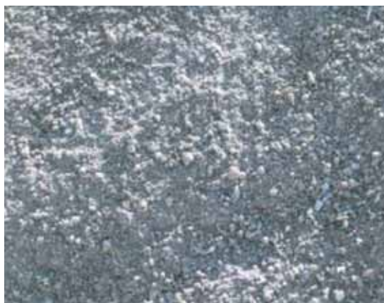
Imagen 2. RCD's acopiados tras su valorización y reciclado.
