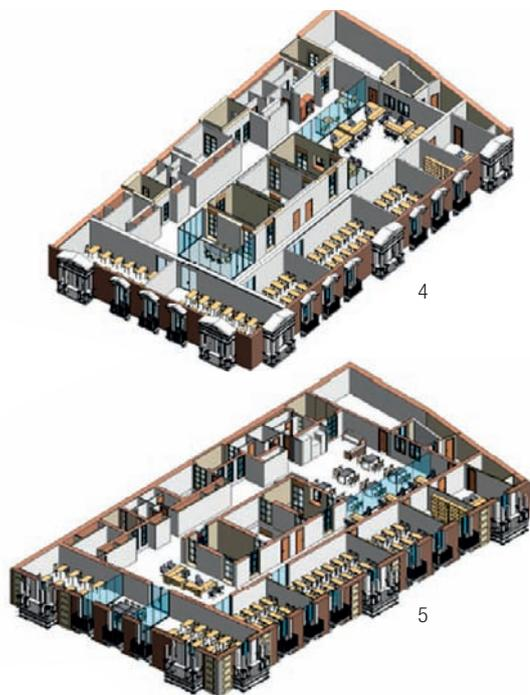
4 y 5. Secciones de dos plantas de la sede colegial, realizadas con máximo detalle gracias a la modelización parametrizada.
