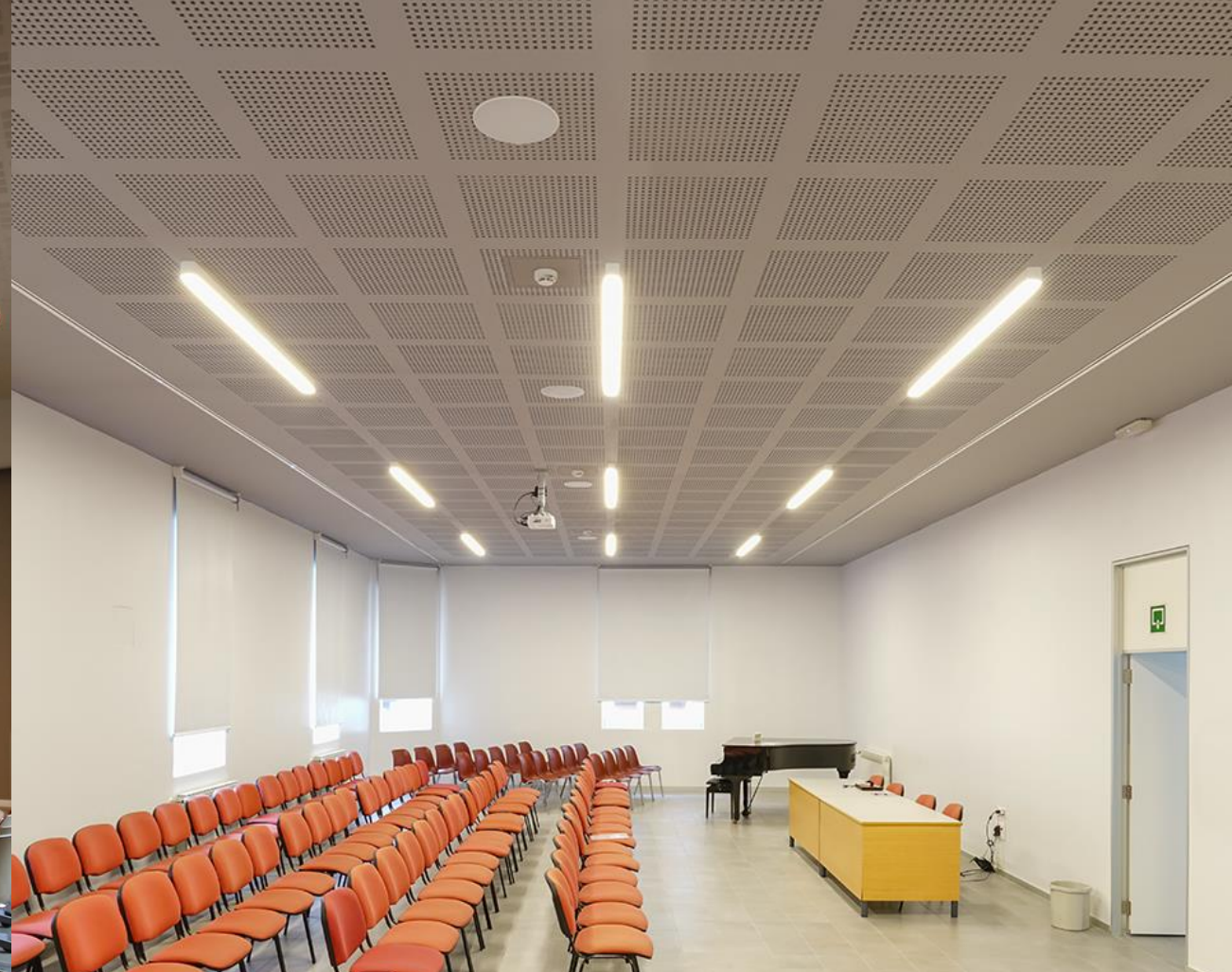
GYPTONE® BIG Tipo Quattro Placas perforadas fonoabsorbentes
